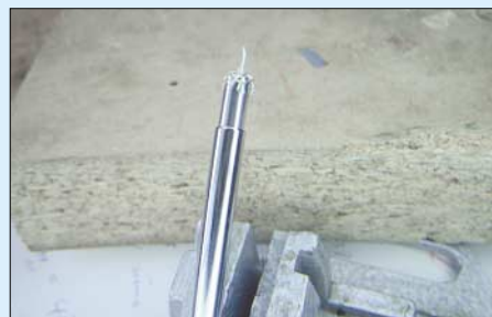
Bild 4: Das Koaxialkabel wird von unten durch den Sperrtopf geführt und oben das Abschirmgeflecht mit dem Sperrtopf verlötet.
