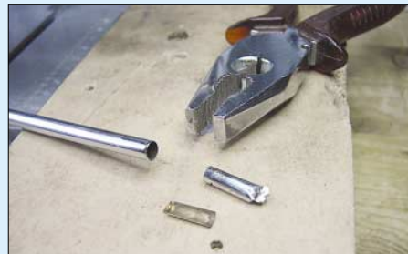
Bild 3: Die abgesägten Teleskopteile werden mit einer Zange aus den benötigten Teleskopröhrchen herausgezogen. Dabei fallen auch zwei kupferne, halbschalenförmige Kontaktfedern heraus, die als Schleifer zwischen den verschiebbaren Teleskopstücken dienen.
