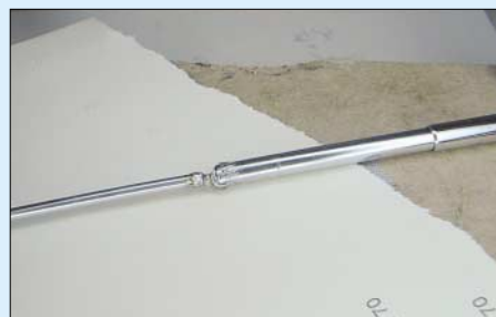
Bild 5: Nach dem sorgfältigen Ausrichten von Sperrtopf und Strahler fixiert der Schnellkleber „Tröpfchen für Tröpfchen“ die aufzubauende mechanische Verbindung.
