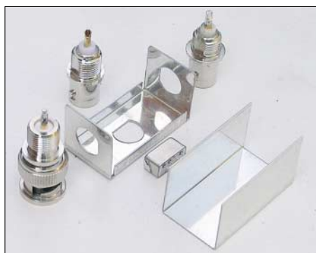
Bild 12: Bauteile für den Messkopf mit TDC-10-1; es findet ein werkseitig modifiziertes Filtergehäuse FG1 Verwendung.
