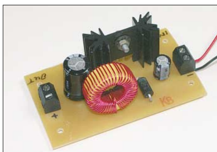
Bild 3: Schaltregler für feste Ausgangsspannungen
