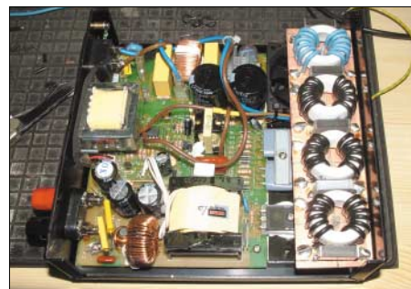
Bild 4: Blick auf das ins Netzteilgehäuse montierte Filter mit liegend montierten Ringkernen
