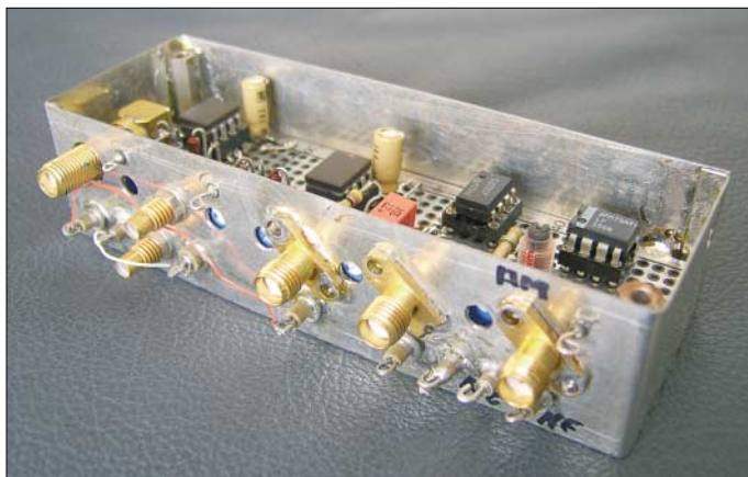
Bild 1: Ansicht eines Musteraufbaus des ZF-Verstärkers auf einer HF-Europlatine
