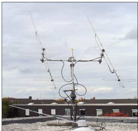
Zwei Elfelement-Yagis auf dem Flachdach, und EME kann losgehen. Foto: DL9LBH
