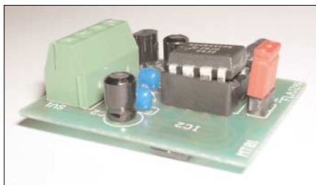
Bild 1: Einsatzbereites Thermometermodul mit Sprachausgabe
