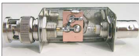
Bild 4: Platine und Widerstände der einfachen Messbrücke sind eingelötet.
