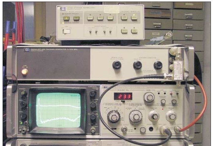
Bild 3: Messaufbau bei DG1UGA; oben Speicherzusatz zur gleichzeitigen Darstellung von Vor- und Rücklauf; in der Mitte Trackinggenerator, eingestellt 100 kHz bis 1 GHz. Der Prüfling steckt direkt am Ausgang. Unten Analysator mit Darstellung der frequenzabhängigen Richtschärfe als Abstand der beiden Kurven (obere Vorlauf, untere Reflexionsfaktorverlauf).
