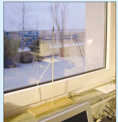
Bild 7: Erster Testaufbau der Sperrtopfantenne
