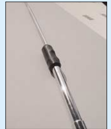
Bild 6: Der über die Verklebung gezogene Schrumpfschlauch gibt der neuen Antenne den letzten optischen Schliff.
