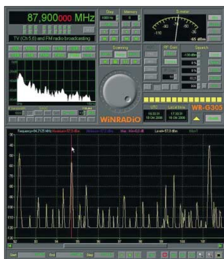
Bild 2: Programm-Oberfläche mit geöffneter Band-Scope Anzeige
